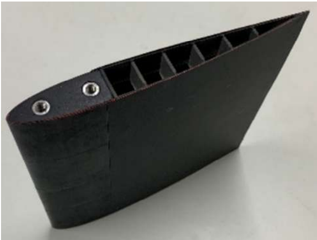
図 10 受動的モーフィング翼模型
