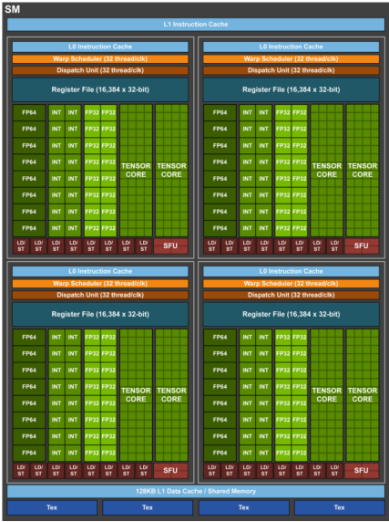
図21 Volta GV100のSM のブロック図[20]
