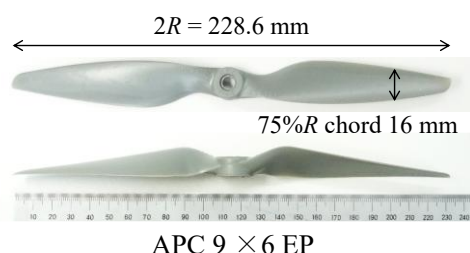
図6 実験に用いたロータ (APC 9×6EP)
