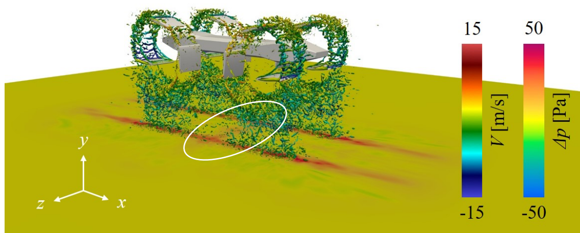
図3 サイクロローターUAV周りの流れ場の可視化. 等値面は速度勾配テンソルの第二不変量 Q (=500,000) をy方向の速度成分 ( V ) で色付けしたもの. z - x 平面は圧力分布 ( \Delta p = p - p_0 ) を示す.
