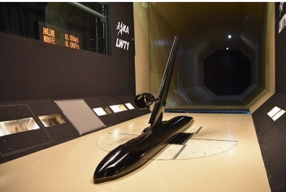
図 8：LWT1 ストラットカートに設置した CRM-HL 模型
