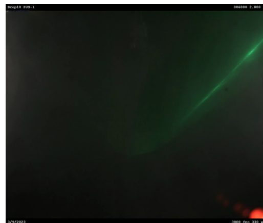
(c) t=2.00\text{sec} (噴射開始後1.0sec後) 図 17 FJS-1の微小重力実験結果
