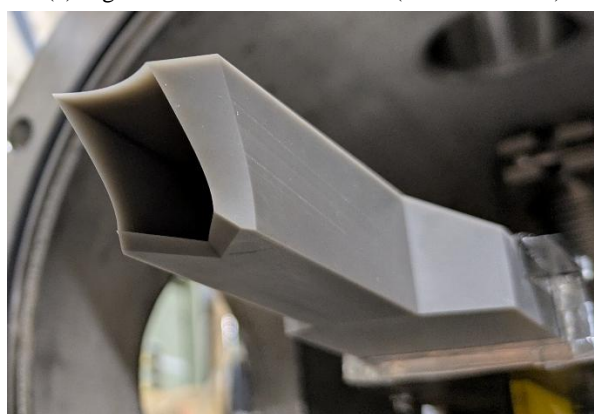
(c)矩形Busemannインテーク (境界層補正有，アスペクト比=1)
