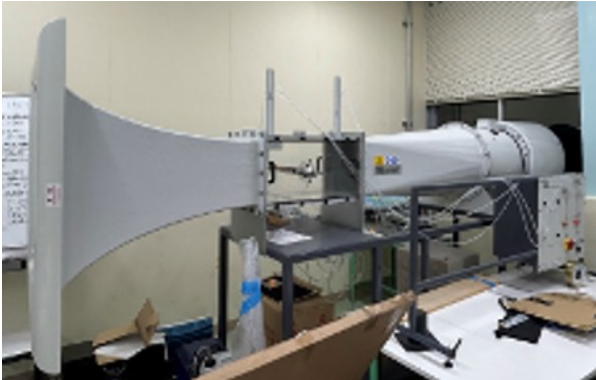
図2 吸込み式風洞（ TecQupment 社製AF-100）
