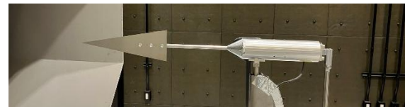
a) デルタ翼模型と翼模型支持装置
